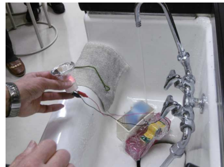
水力発電用のモーターを使用
