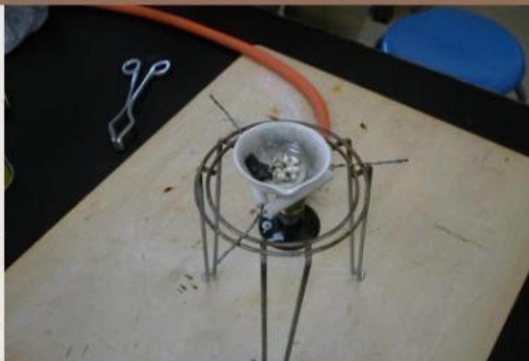
スズ10gと木炭ひとかけらを蒸発皿に入れ、ガスバーナーで下から加熱する。
