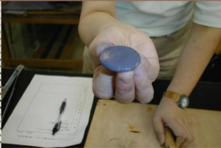
完全に冷えたら、蒸発皿から取り出します。
