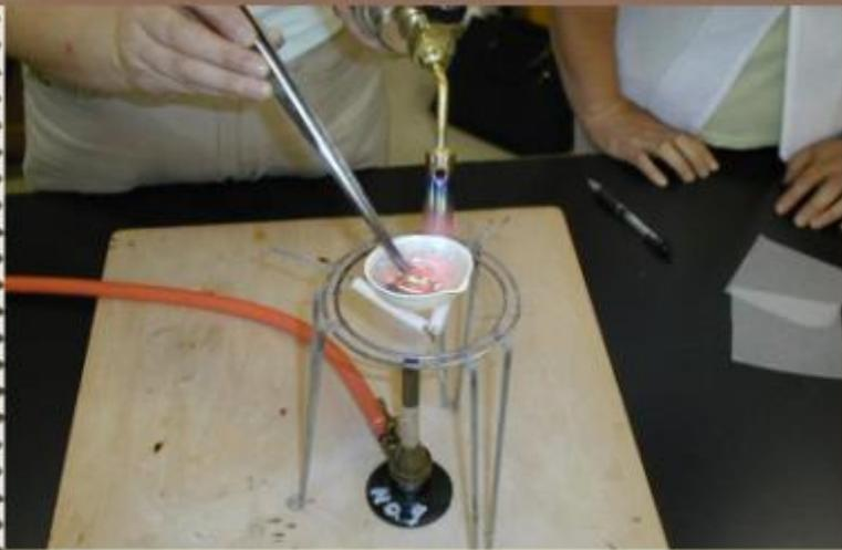
● 全部の銅板を融かし終わったら、鉄の棒(ピンセット)で、合金をかき混ぜます。
