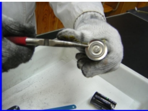
乾電池のプラス極のふたを取り外す。
