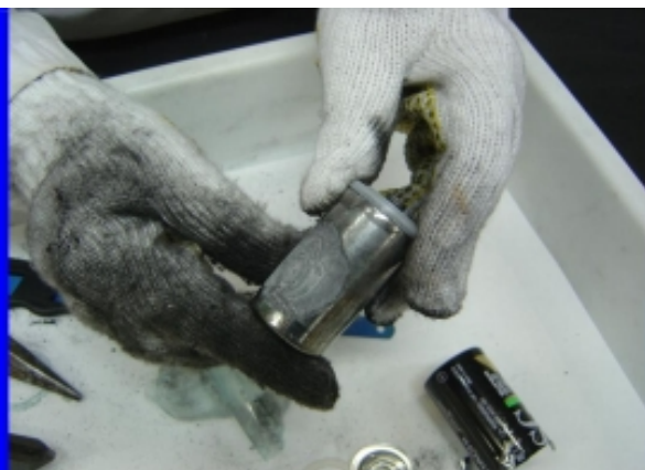
マイナス極の亜鉛が姿をさらす。使い古した電池だと腐食している様子が分かる。
